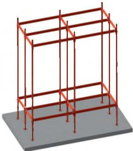
1. На стартовые стойки устанавливаются стойки доборные в соответствии с монтажной схемой;
