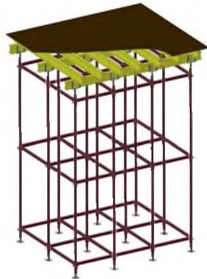
Рис. 19. Пример опалубки перекрытий с использованием объемных стоек
