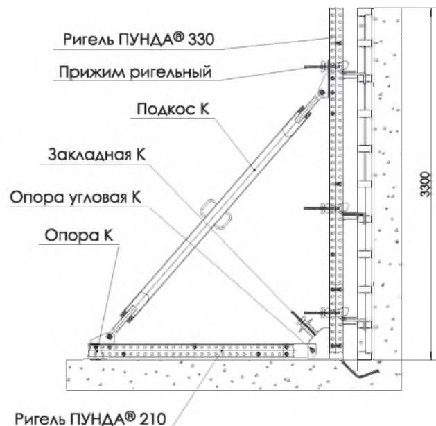
Рис. 22. Пример односторонней опалубки стен (для отдельных проектов вид и комплектность опалубки может отличаться)
